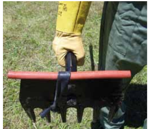
Figura 59. Protección del filo
