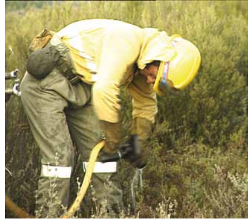
Figura 82. Desenganche de la lanza
