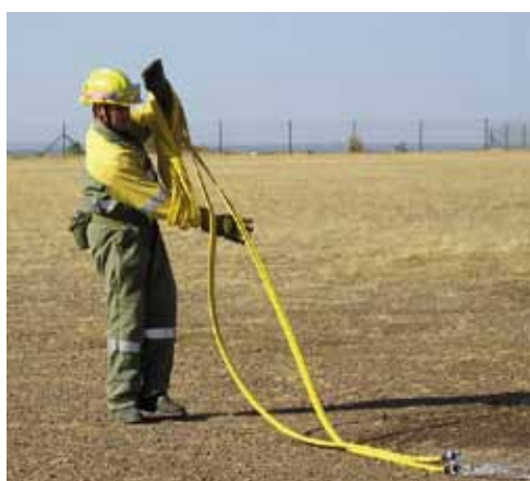
Figuras 88. Recogida de tendido en ocho doble
