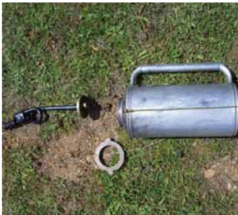
Figura 63 y 64. Antorcha de goteo
