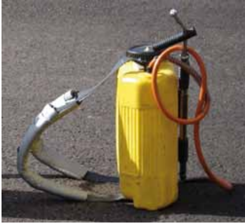
Figura 52. Extintor de mochila
