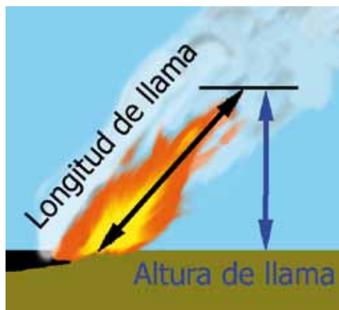
Figura 8. Diferencia entre altura y longitud de llama
