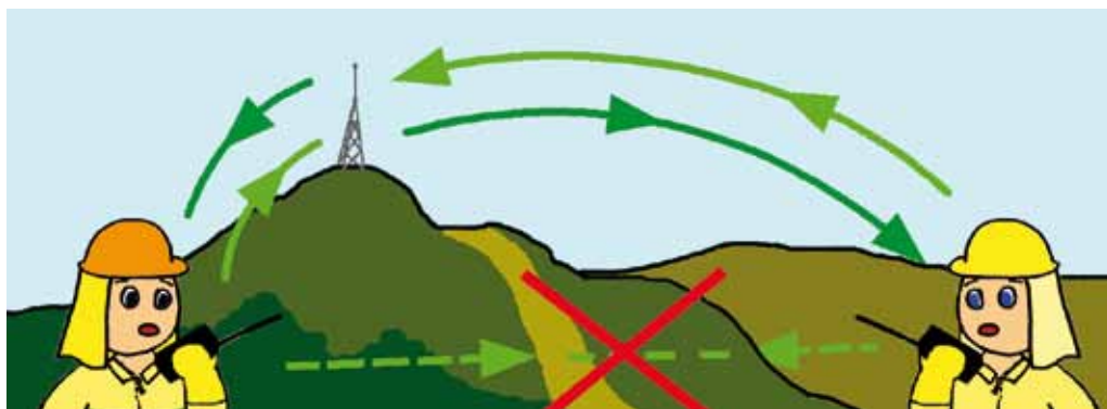
Figura 96. Funcionamiento canal en semidúplex
