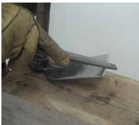
Figura 73. Afilado de la azada
