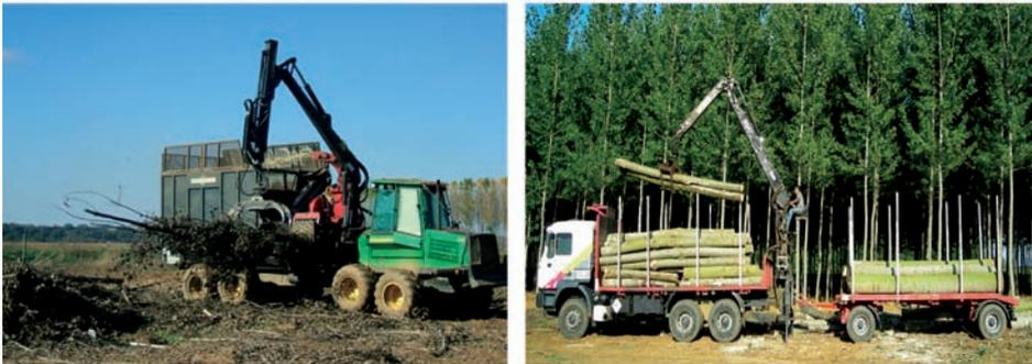
Fig. 7 y 8: Astilladora Erjo (izquierda) y camión rígido con remolque y grúa cargando las trozas (derecha).
