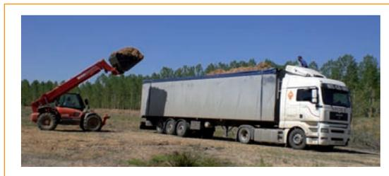
Figura 13: Pala auxiliar necesaria si se descarga en suelo
