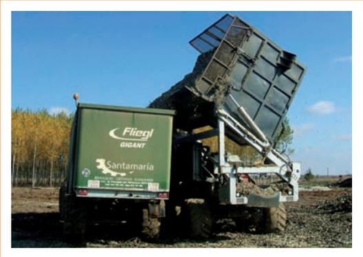
**Fig. 15:** Astilladora volcando su contenido sobre tractor con remolque
