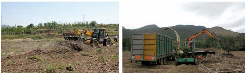
*Fig. 9 y 10: Acordonamiento de restos con pala telescópica con rastrillo (izquierda) y astillado móvil con astilladora Pezzolato 480/660 (derecha), en el Sistema 3.*
