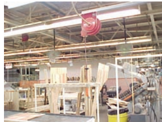
Figura 89. Sistema de enrollado superior para herramienta neumática.
