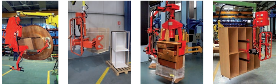
Figura 126. Manipuladores con implementos para la toma y manipulación de muebles.
