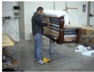
Figura 84. Columna con ajuste de ángulo de trabajo.
