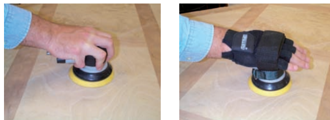
Figura 47. Postura de la mano con y sin guante anti-vibración con sistema de arnés para reducir la fuerza estática de agarre.
