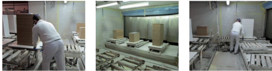
Figura 61. Sistema de transporte de piezas con rodillos.
