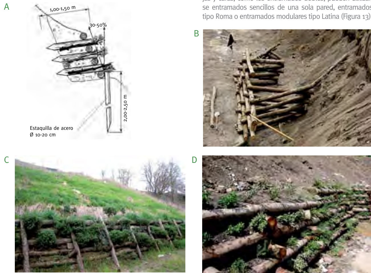
Figura 13. Entramado sencillo de una pared (A, tomado de Florineth 2004), entramado tipo 'Roma' (Paolo Cornellini, B), y entramado tipo 'Latina' (Paolo Cornellini y Sauli; 2005, C y D).
