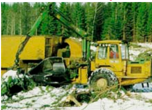
Ilustración 4. Astilladora en cargadero
