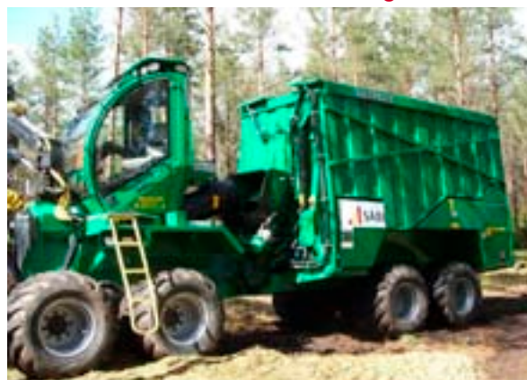
Ilustración 6. Astilladora en cargadero
