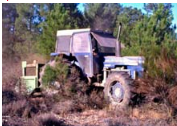
Ilustración 12. Desbroce mecanizado por trituración mediante tractor agrícola con apero desbrozador de martillos
