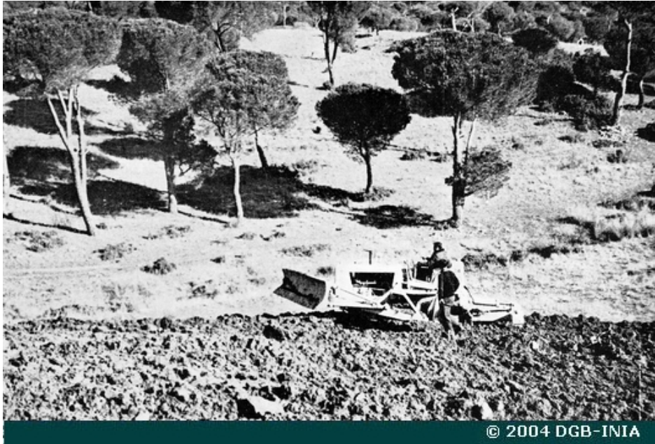
Foto 29: Utilización de ripper para la preparación del suelo para su repoblación con Pinus pinea, en Almorox (Toledo) (1968). (Foto: Fototeca Forestal Española DGB- INIA. Memorias de ICONA)
