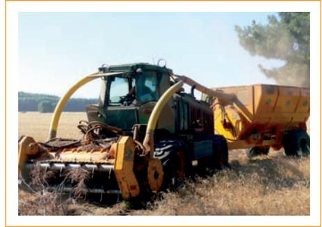
*Fig. 44: Máquina trituradora de matorral y restos de corta de Serrat y Ramón Marín.*
