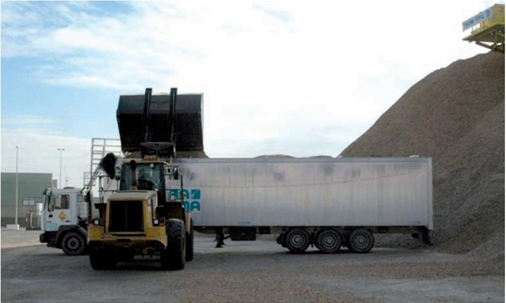
Fig 56: Carga de astilla con pala cargadora en un camión semi-remolque de "piso móvil". Fuente: ENCE
