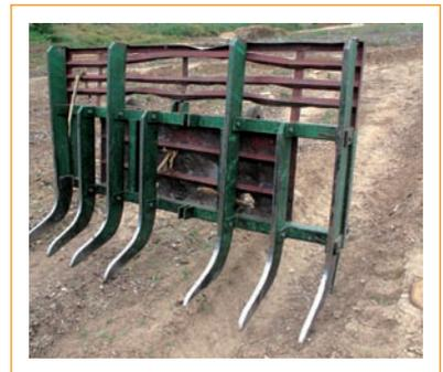
Fig. 32: Apero para reunión de restos ("rastrillo") acoplable a una cargadora telescópica.
