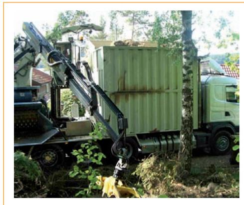
Fig. 61: Grúa y Alimentación de una astilladora integrada en camión
