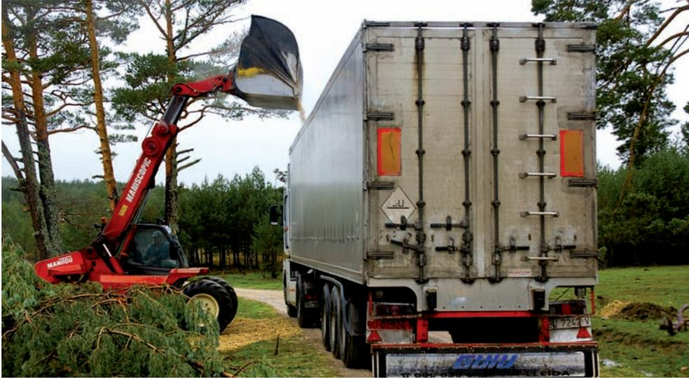
Fig. 31: Cargadora de brazo telescópico alimentando un camión de piso móvil.
