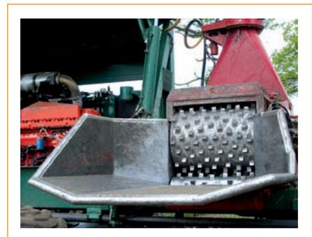
Fig. 14: Mesa alimentadora de astilladora móvil.
