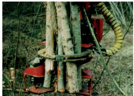
Fig. 35: Cabezal multitalador.
