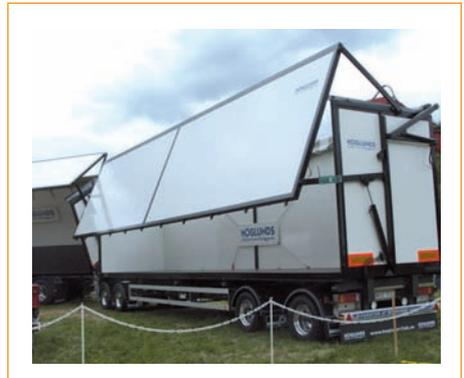
Fig. 58: Remolque de camión de astilla con otro tipo de descarga lateral.
