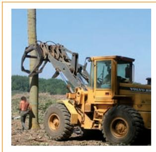
*Fig. 26: Cargador frontal auxiliando el apeo de un chopo.*
