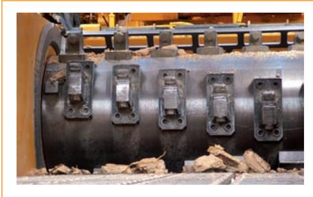
Fig. 8: Útil de triturado con martillos fijos
