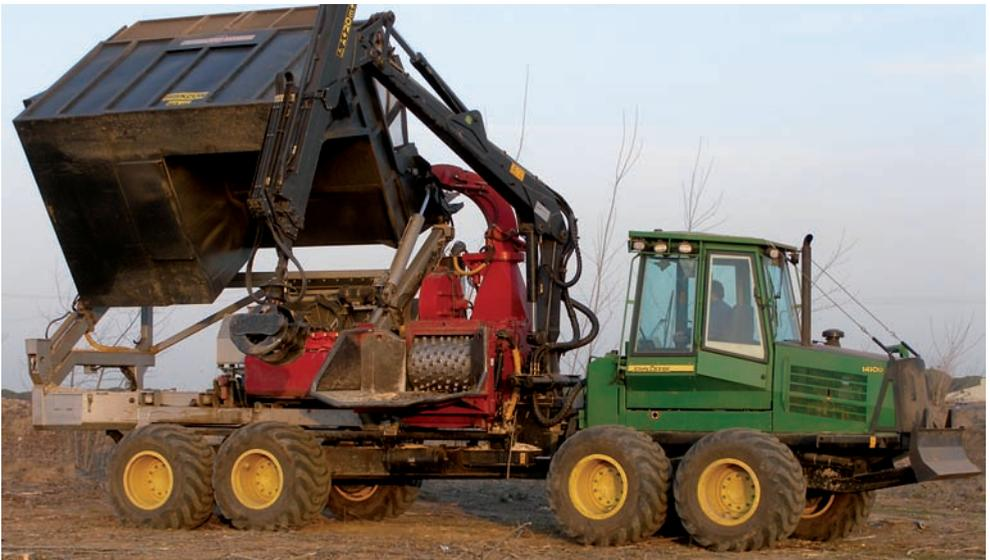
Fig 50: Tractor (astilladora móvil) con remolque basculante
