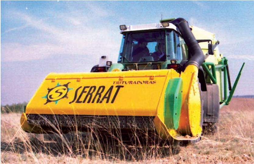
Fig. 42: Apero desbrozador y ciclón de una cosechadora de matorral Serrat
