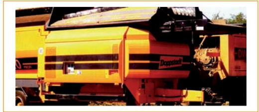
Fig. 19: Criba de discos a la entrada de un trommel.
