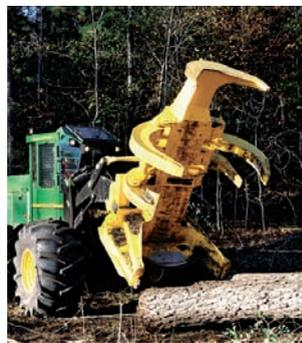
Fig. 38: Cabezal multitalador pesado de sierra circular.
