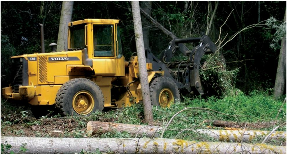
Fig. 22: Cargadora frontal apilando ramas en una chopera
