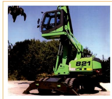
Fig. 29: Cargadora rotatoria de ruedas, anclada.
