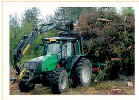
Fig. 55: Remolque extensible en tractor Valtra
