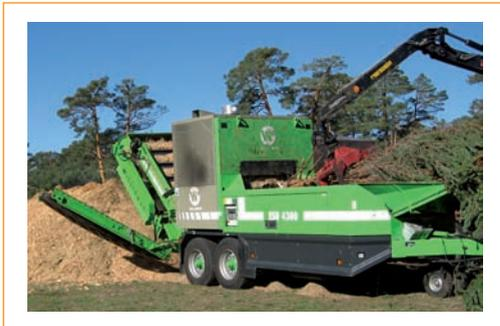
Fig 6: Alimentación con grúa de vehículo auxiliar
