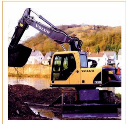
Fig. 30: Apero de retroexcavadora convencional
