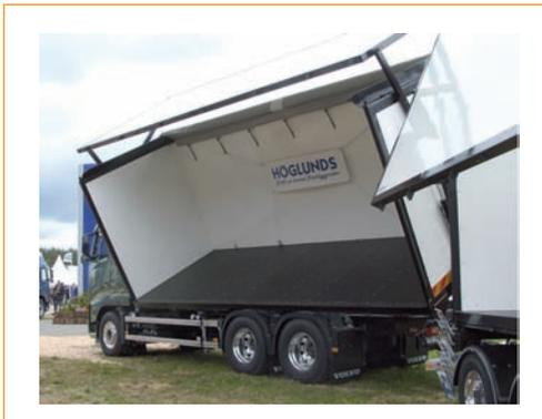
Fig. 57: Camión sueco de astilla con descarga lateral.
