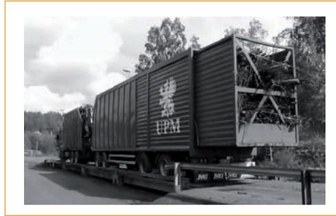
Fig. 59: Camión finlandés con remolque telescópico
