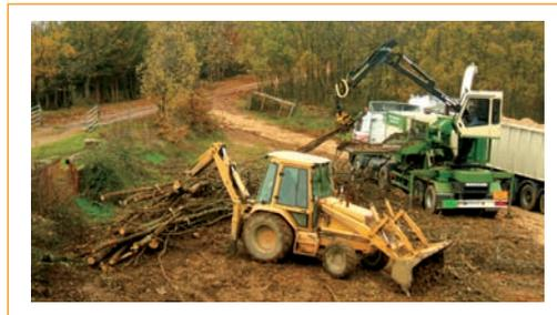
Fig. 24: Pala cargadora con grúa de retroexcavadora adicional.
