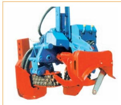
Fig. 34: Cabezal cosechador con motosierra adicional para despunte.
