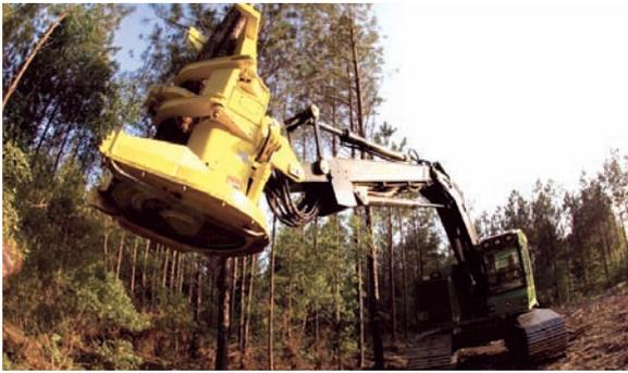
Fig. 37: Cabezal multitalador pesado
