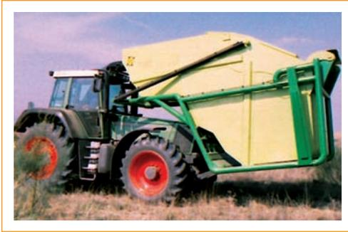
*Fig. 43: Depósito contenedor de una cosechadora de matorral*
