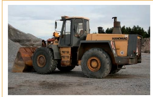
Fig. 23: Pala cargadora.
