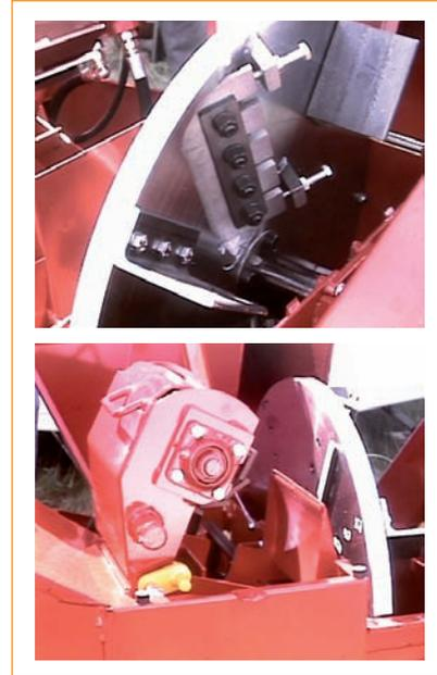
Fig. 11, a y b: Detalles del disco, cuchillas y palas del ciclón ventilador
