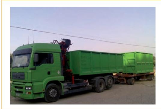
Fig. 64: Camión de contenedores con remolque y grúa.
