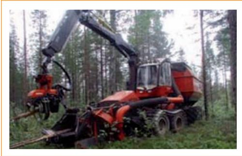
Fig. 40: Multitaladora - astilladora
