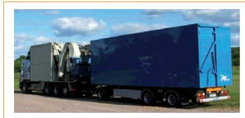
Fig. 60: camión sueco con remolque y astilladora integrada
