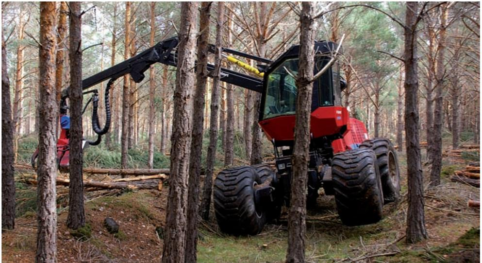
Fig 33: Cosechadora convencional cortando y apilando árboles completos en una clara
