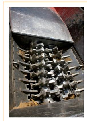
Fig 3: Útil pretriturador de doble tornillo
