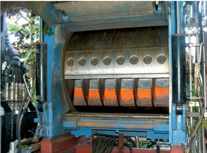
Fig 10: Útil de una astilladora de tambor
