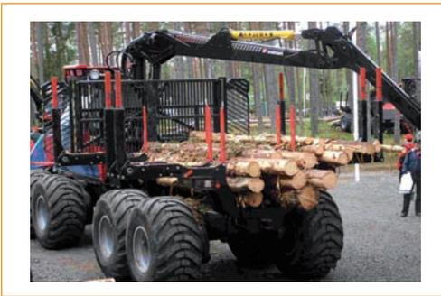
Fig. 54: Remolque de teleros extensibles en autocargador Valmet.
