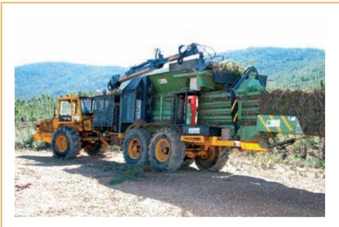
Fig. 47: Empacadora Trabisa sobre autocargador de ruedas
