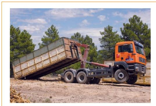
Fig. 66: Sistema longitudinal de carga de contenedores en camión "multilift"
