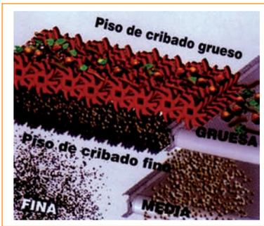
Fig. 18b: Esquema de doble criba de estrellas.
