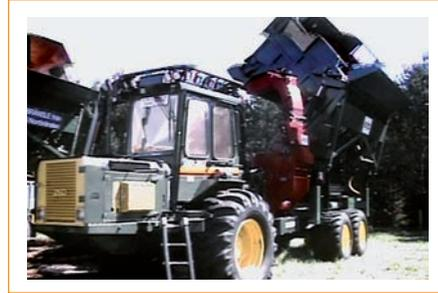
Fig. 15: Astilladora móvil con contenedor basculante.
