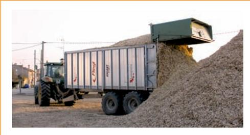
Fig. 51: Tractor con remolque de descarga trasera forzada.
